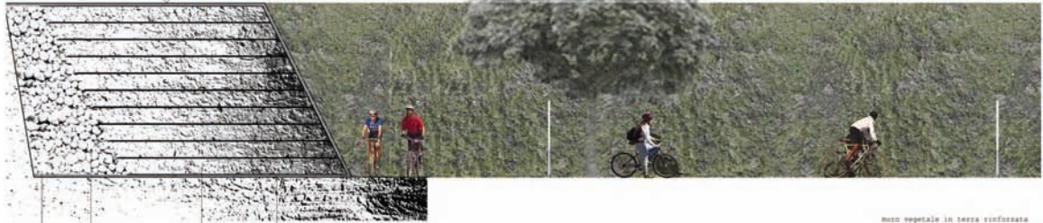
muro vegetale in terra rinforzata
