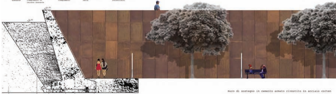
muro di sostegno in cemento armato rivestito in acciaio corten
