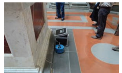
FIG.1A-C Foto della stazione sismica B09 installata alla base del piedistallo del David (TRI2). Nell'acquisizione sono stati impiegati sensori sismici triassiali Lennartz 3D/5sec e digitalizzatori Guralp CMG-DM24. I dati sismici sono stati poi memorizzati su dischi rigidi Guralp
