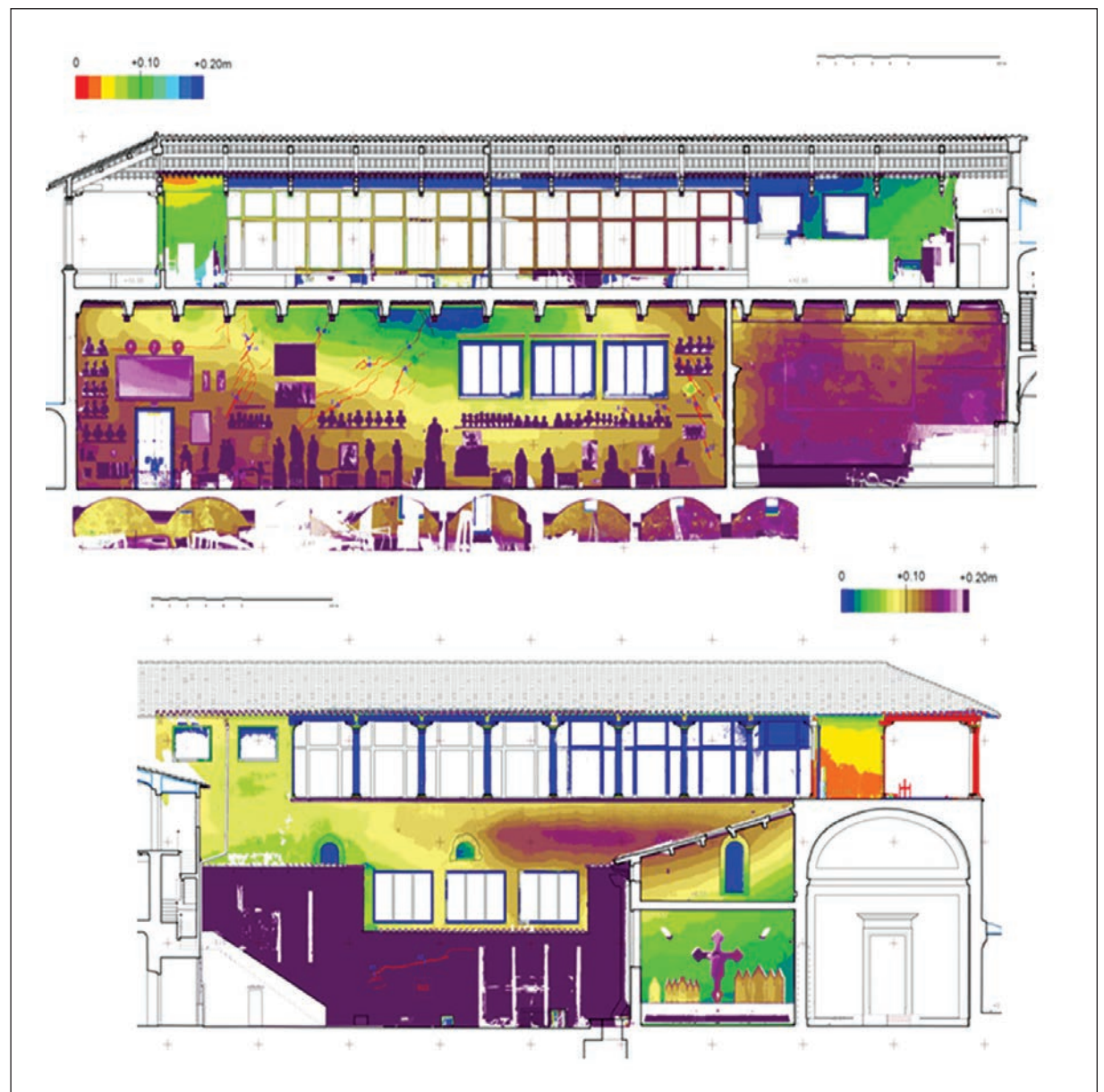
FIG.15 Parete est (interno/esterno) della Gipsoteca (piano terra della Galleria) e delle Aule di Pittura (piano primo dell'Accademia di Belle Arti). Il modello di punti può consentire la valutazione delle possibili deformazioni della struttura, graficizzando, con mappe di scostamento, le distanze tra una geometria ideale (piani verticali) e quella rilevata su entrambe le facce della muratura.
