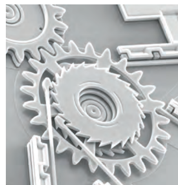
Sandia National Laboratories SUMMIT Technologies, micro attuatore meccanico.
