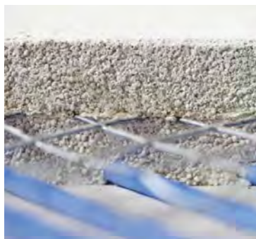
Sopra: Le microparticelle PCM vengono facilmente incorporate nei materiali da costruzione come gesso o cemento e svolgono il loro compito di "heat buffer"
