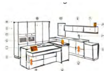
Sotto: Schizzo del principio di funzionamento delle cucine KIMO-CON ad altezza regolabile, esempio di accessibilità e dell'"internet of things".
