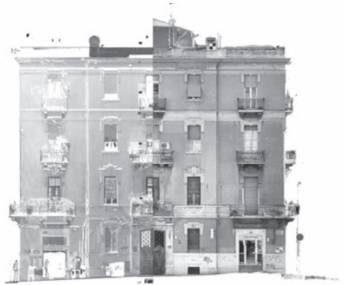
Mappature fig. 10 Confronto orto-foto dati TLS e fotogrammetrici.
