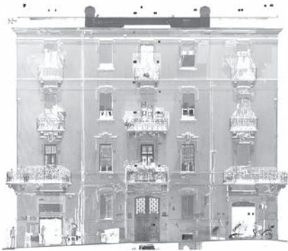
Mappature fig. 9 Vista ortografica del prospetto principale dati TLS.
