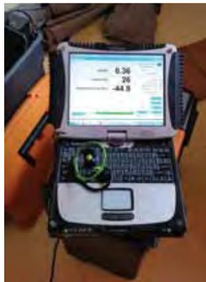
FIG.19 | RICERCA DI INFILTRAZIONI DI ARIA CON L'ANEMOMETRO
