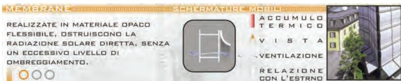
Una membrana è un elemento di controllo fatto di materiale traslucido flessibile, messo all'esterno dell'involucro per ostacolare o diffondere la radiazione solare diretta. Una interessante evoluzione sperimentale di tale elemento è rappresentata in questi ultimi anni dall'ETFL, l'etiltetrafluoretilene, che combina insieme doti di leggerezza e di resistenza con alte prestazioni di trasmissione della luce e d'isolamento termico (quando usato in più strati).
