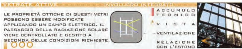
La tipologia delle vetrate attive si caratterizza come elemento di controllo attivo nell'involucro che può cambiare le sue proprietà ottiche applicando un campo elettrico esterno. La luce naturale attraversa l'involucro e ne controlla l'intensità secondo la condizione interna richiesta. Le sue dimensioni variano in funzione delle dimensioni dell'apertura da coprire. È una struttura di multi-strato complessa fatta di materiali ad alta tecnologia.
