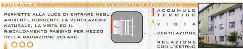
Essa permette la penetrazione laterale della luce o della radiazione solare diretta, la vista e la ventilazione naturale. Una finestra aumenta il livello di luminosità nelle zone interne, ma tale livello di luce diminuisce man mano che la distanza dalla finestra aumenta. Ampiezza e dimensioni d'altezza possono variare dalle piccole finestre di 0.1 m a più di 6 m. La serie tipica è tra 1.2 e 1.8 m in altezza e tra 0.8 e 2.5 m in ampiezza.
